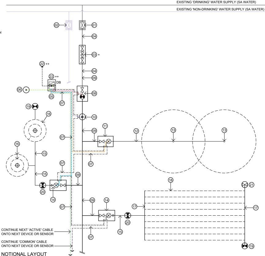
COMMERCIAL CONTROLLER WITH MULTICORE CABLING CoA 633
